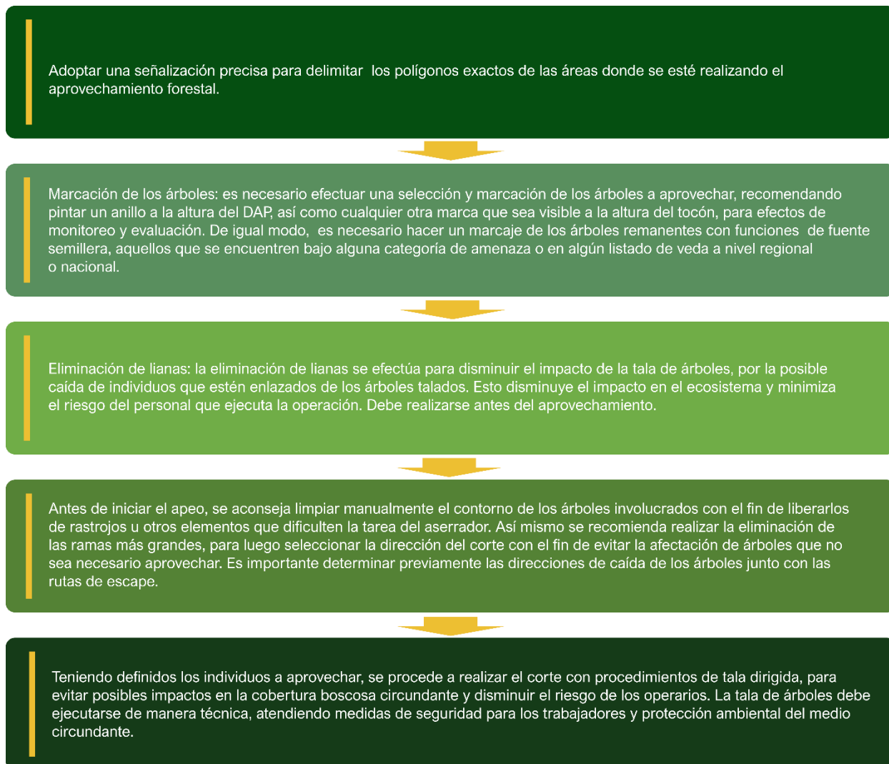
Figura 12. Principales pasos en la tala dirigida.
