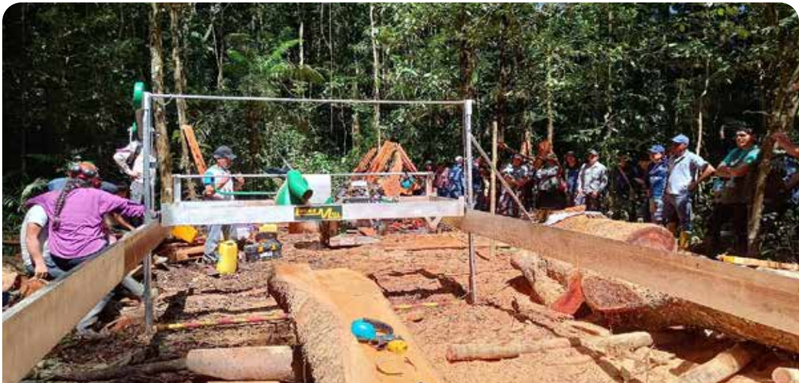
Figura 45. Aserradero portátil Lucas Mill
